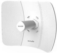
**TENDA ANTENA DIRECCIONAL O8 23DBI 5GHZ**
